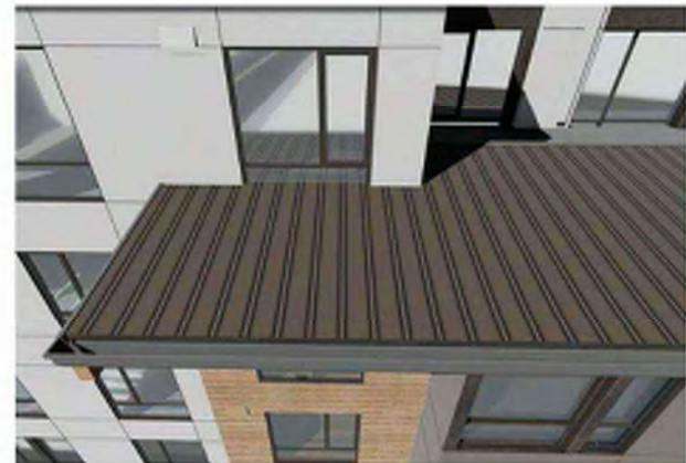
E1 STANDING SEAM METAL ROOF
