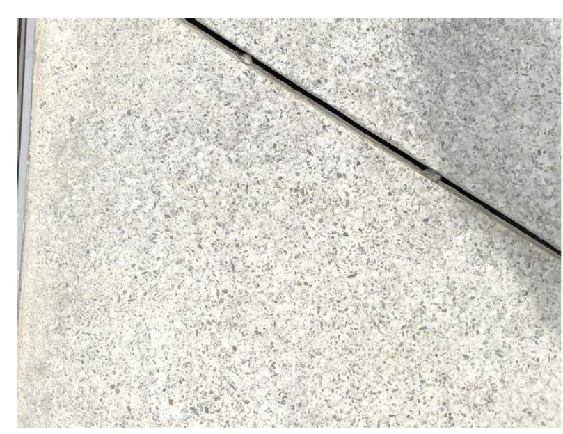
SAMPLE PAVING - CONCRETE - SEEDED
