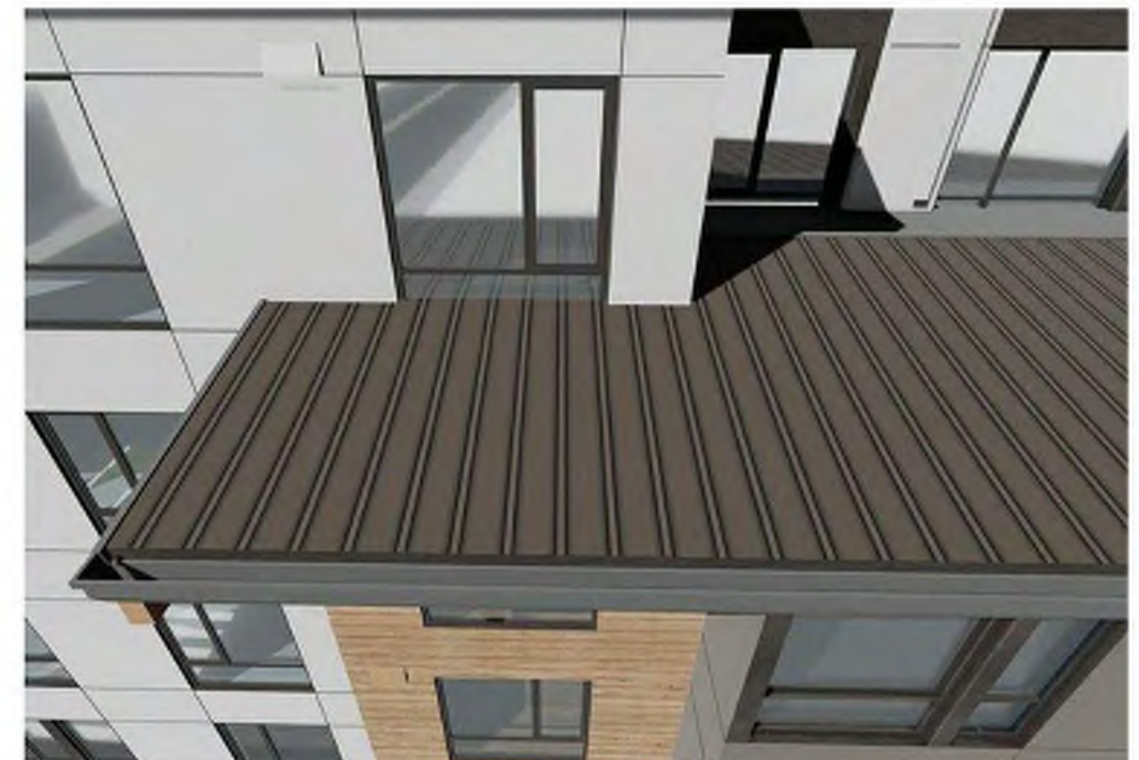
E1 STANDING SEAM METAL ROOF
